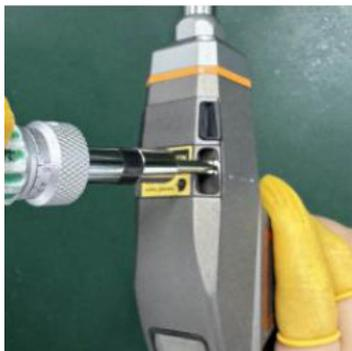
图 1：用螺丝刀拆解聚焦镜座螺丝
