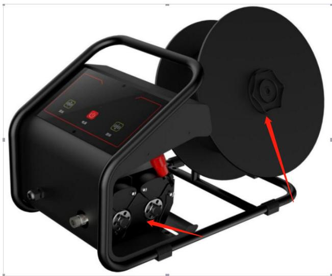
第一步：如上图送丝转盘组件所示，拆卸转盘固定螺母，将焊丝盘安放至送丝转盘，且焊丝出丝按照顺时针朝向出丝，锁紧转盘的固定螺母；
