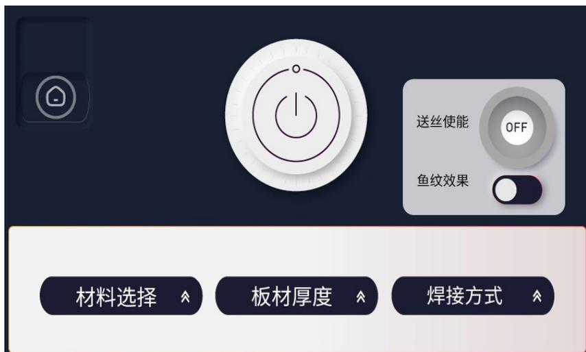
点击精简模式界面中间的启动按钮，会弹出“设备即将启动”提示弹窗，如下图，请注意安全防护，再次点击确认后就正式启动了。
