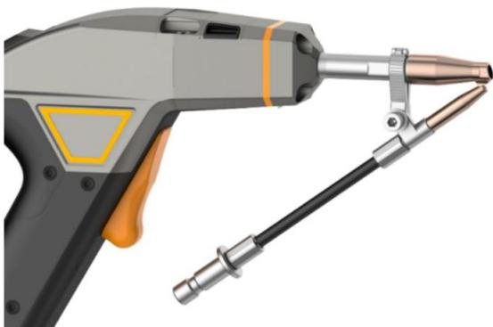
第二步：固定送丝架，调整送丝嘴至焊接铜嘴丝槽中间部分，将送丝组件卡至枪管卡槽内，最后锁紧螺丝。
